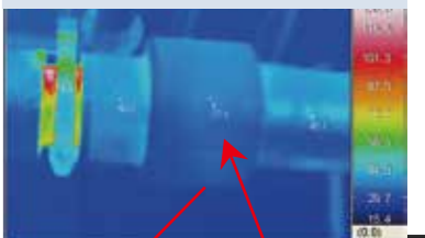
ヒートキャップ取付後
